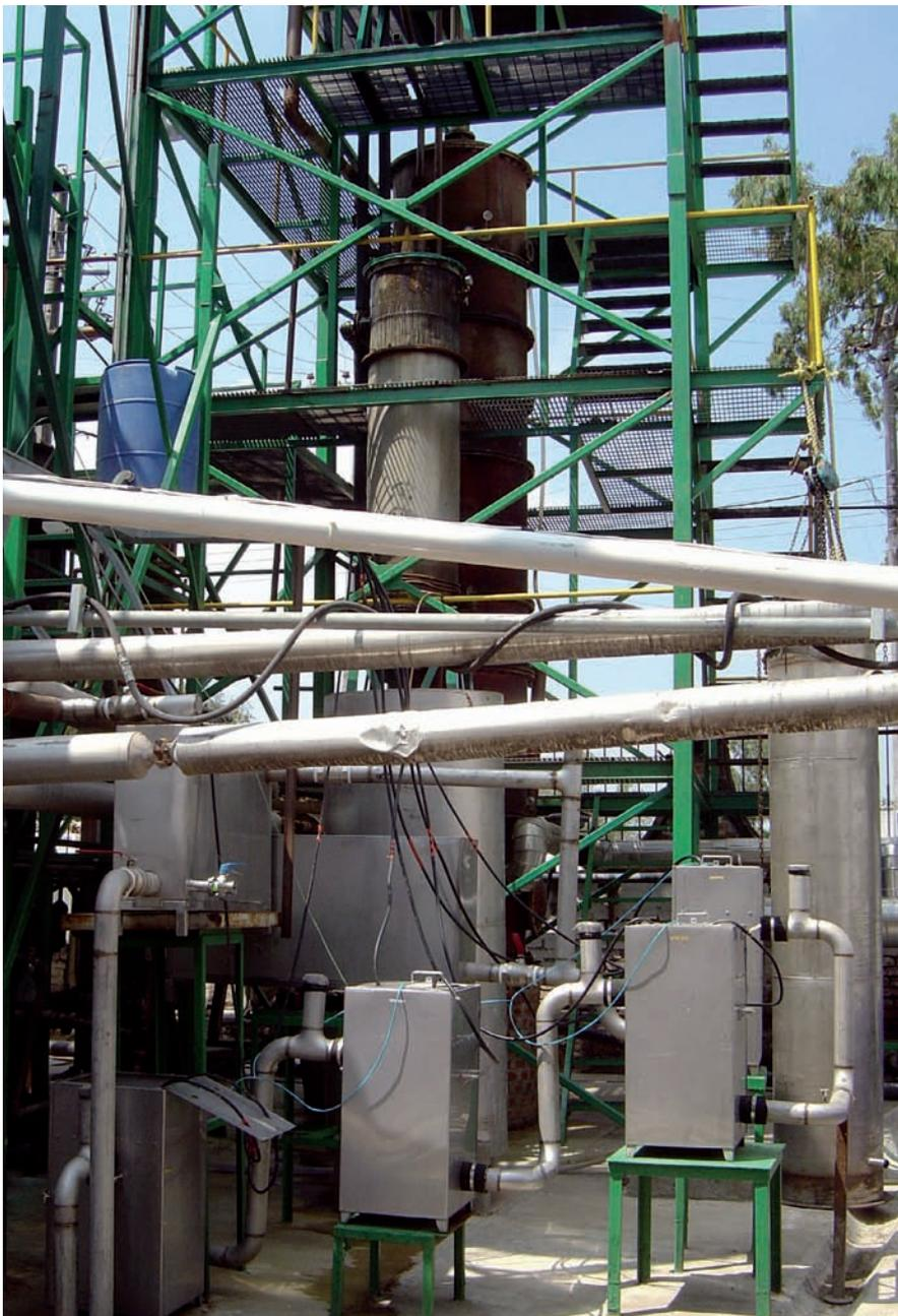
Abwasserreinigung auf mexikanisch: Selbstgebaute Diamant-Elektroden-Reaktor-Kaskade (5 m<sup>3</sup>/h) der mexikanischen Tequilera Corralejo
