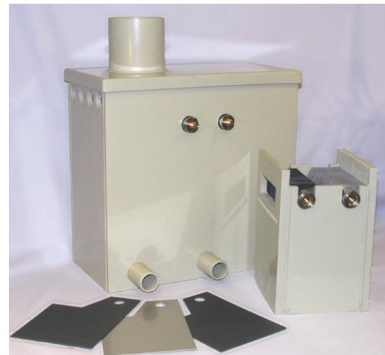
2: Elektrolysezelle mit Diamantelektroden für Batch und kontinuierlichen Betrieb zur Entfernung von biologisch nicht abbaubaren Abwasserinhaltsstoffen
